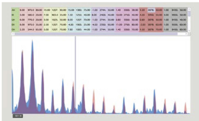
図2：肉声と人工音声のスペクトルを比較しながらフォルマント・パラメータ値を調整する様子
