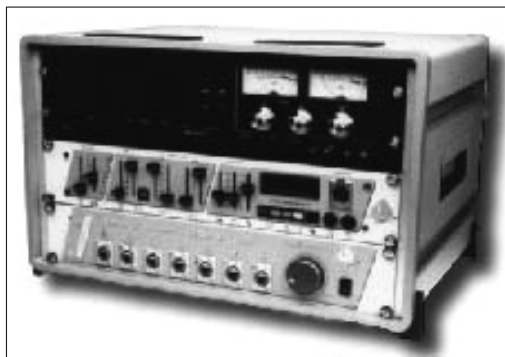
図2：上段：音声再生機、中段：電子耳装置、下段：音声分配器
