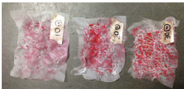
図5/ニードルパンチ済 試料 染料塗布結果 試料:シルクオーガンジー 染料:スオウ 媒染剤:アルミ
