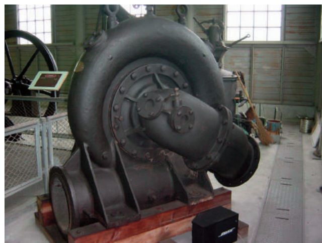
写真9: みのくち式渦巻ポンプ (1912年製作、博物館明治村に展示、2003年6月筆者撮影)
