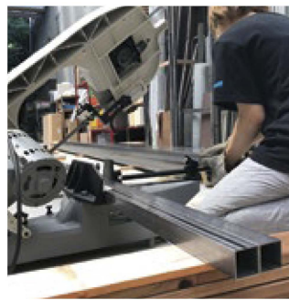
図3/38mm角パイプの切断作業。
