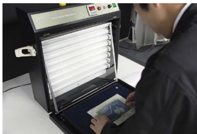
図6/真空密着式の紫外線露光機を使用すると像はシャープに仕上がる
