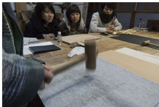
図4/打ち紙の様子(15分交代で数時間打ち続けた)
