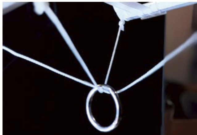
(Pic.19) ドローンと紐を結ぶために装着されたリングの様子
