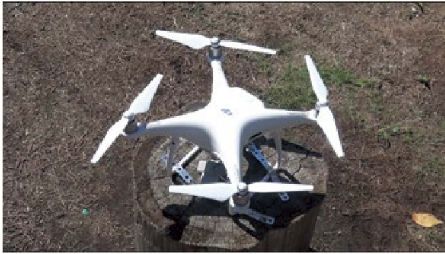
(Pic.2) 切り株にスチール製の板を使用し木ネジ止めでDroneを固定。
