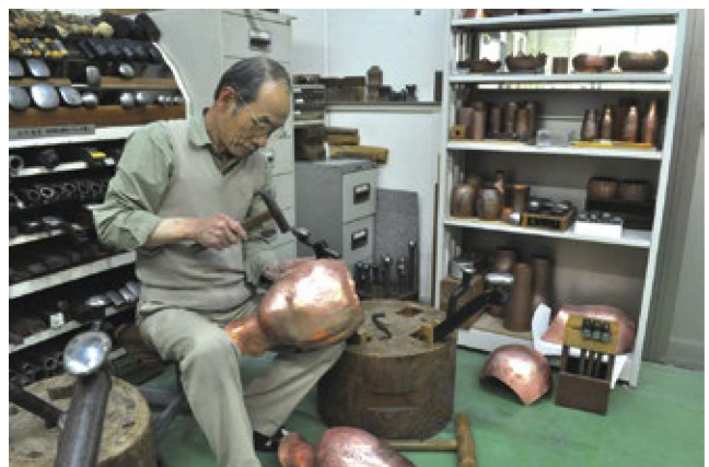
写真17: 「絞り」技法による成形
