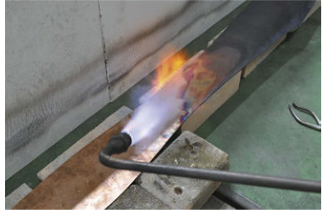
写真11:銅板を焼き鈍す
