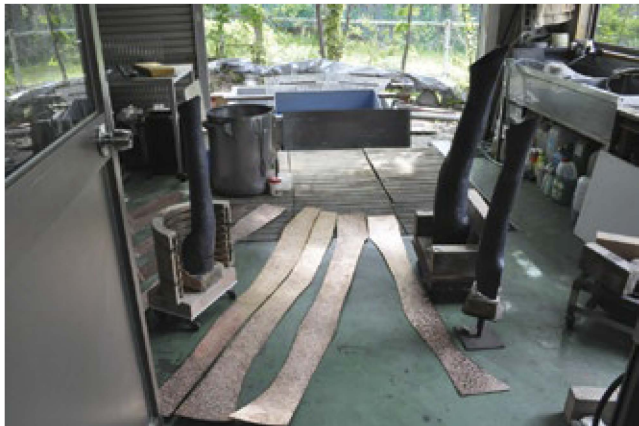
写真13: 焼き鈍した銅板を酸洗いのする
