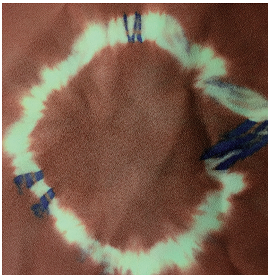
図1 / 絞り布の染色試験結果(染色温度 上80°C、中90°C、下100°C)
