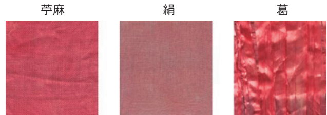
写真1:インド茜(チップ) アルミニウム媒染 試料写真
