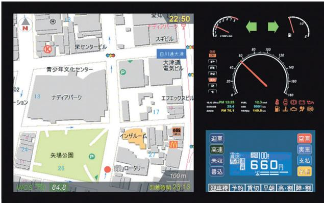
図21: 運転手のためのインタフェースの提案
