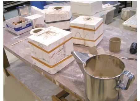
写真7:鑄込みの作業
