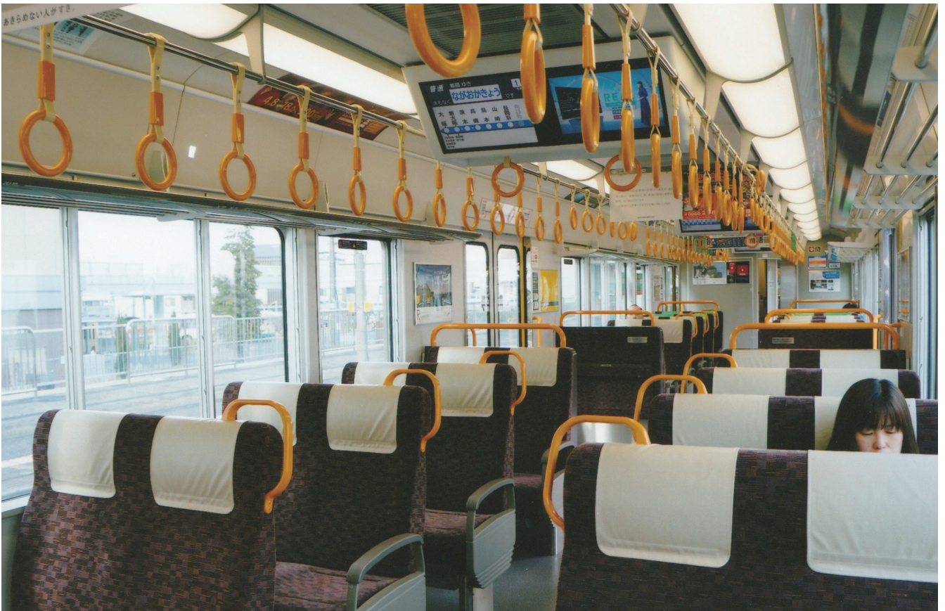
写真2:225系電車(0番台)の車内／黄色の吊り輪、手すりがずらりと並ぶ
