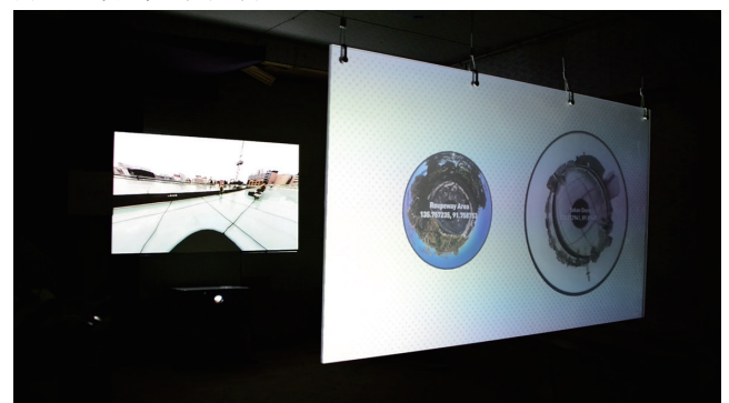
奥(画像左)は布地キャンバススクリーンにフロントプロジェクションで全方位空間を投影。手前(画像右)はアクリルパネルスクリーンにリアプロジェクションで全方位画像を投影。
