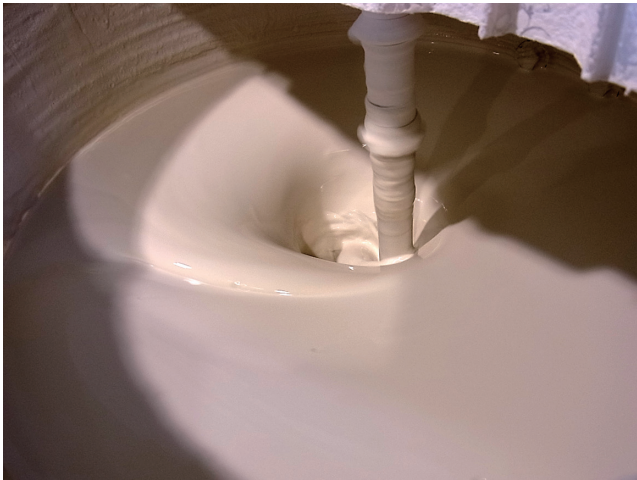
泥漿の攪拌(ニューボン・水・珪酸ソーダ)
