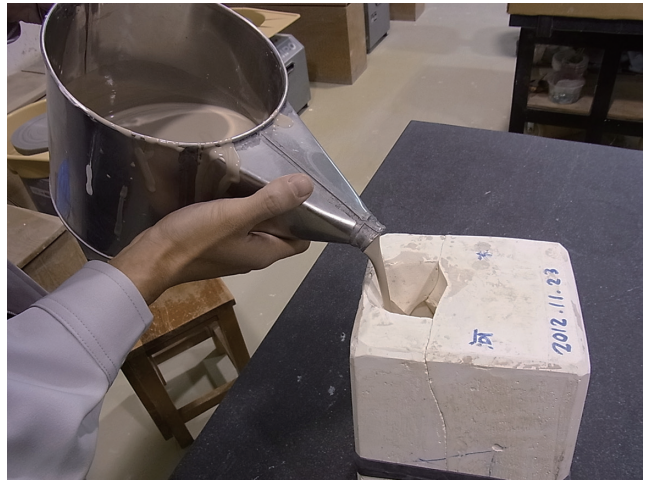
鑄込み(流し込み工程)作業
