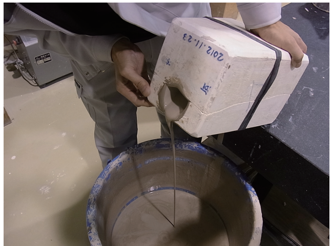
鑄込み(排泥工程)作業
