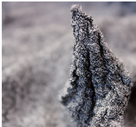
写真6: ウールを縮絨させ形状固定したテクスタイル
