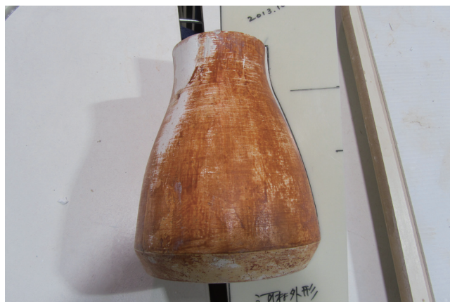
④削出時にアウトゲージを用いる為、図面通りの原型に仕上がる
