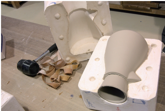
⑦型から製品が取りだされ乾燥後素焼行程にはいる
