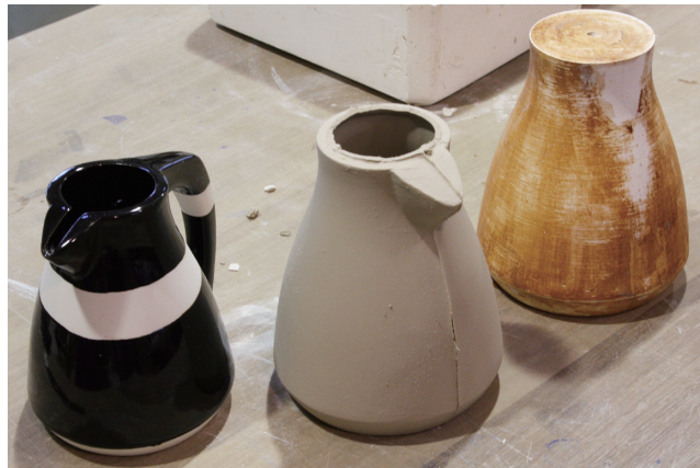
⑨ハンドル取付け、素焼き、施釉、本焼成を経て完成
