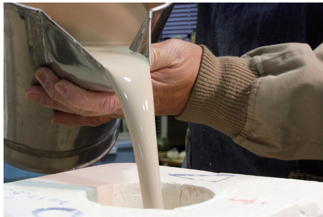
⑥瀬戸産半磁器土を攪拌器にて泥状にして流し込む
