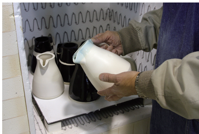
⑩電気炉にて酸化1250℃焼成(所要時間12h)
