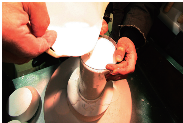
①石膏轆轤に筒状ラミネートフィルムを立て石膏を流し込む
