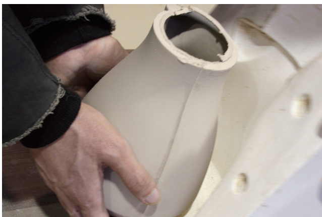
⑧泥漿による鋳込みで原型通りの実作品が取り出され量産品化
